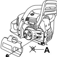
Die Schiene über den Schienenbolzen montieren. Die Schiene in der hintersten Position aufsetzen. Die Kette um das Kettenantriebsrad und in die Schienennut legen. Auf der Oberseite der Schiene beginnen.
