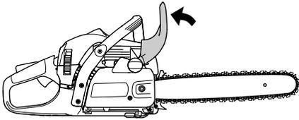
Die Schienenmutter herausdrehen und den Kupplungsdeckel (Kettenbremse) abnehmen. Den Transportschutz (A) entfernen.
