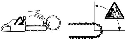
Ein Rückschlag ist immer in Richtung der Führungsschiene gerichtet. Am häufigsten erfolgt der Stoß von Motorsäge und Führungsschiene nach oben und nach hinten zum Anwender. Rückschläge erfolgen aber auch in andere Richtungen, je nachdem in welcher Stellung sich die Motorsäge in dem Augenblick befindet,
