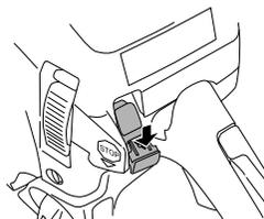
**ACHTUNG!** Der Start/Stopschalter geht automatisch in die Betriebsposition zurück. Um ein ungewolltes Starten zu vermeiden, muss bei Montage, Kontrolle und/oder Wartung daher stets die Zündkappe von der Zündkerze entfernt werden.
