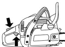
Hinten an der Säge (A) befinden sich vereinfachte, illustrierte Schritt-für-Schritt-Starthinweise.
