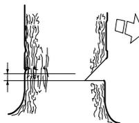
Die Rindenstütze (falls montiert) hinter dem Brechmaß ansetzen. Mit Vollgas sägen und mit der Sägekette/ Führungsschiene langsam in den Baumstamm schneiden. Aufpassen, ob sich der Baumstamm entgegengesetzt zur Fällrichtung bewegt. Einen Fällkeil oder einen Fällheber in den Fällschnitt schieben, sobald die Schnitttiefe dies gestattet.
