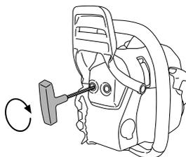
Bestimmte Schalldämpfer sind mit einem speziellen Funkenfangnetz ausgerüstet. Ist Ihr Gerät mit einem derartigen Schalldämpfer ausgestattet, so ist das Netz einmal wöchentlich zu säubern. Dies geschieht am besten mit einer Stahlbürste. Bei Verstopfung des Netzes läuft der Motor heiß, was schwere Motorschäden zur Folge haben kann.
