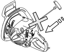
**Hinweis!** Die Kettenbremse rückstellen, indem der Handschutz zum Handgriffbügel geführt wird. Damit ist die Motorsäge bereit zur Anwendung.
