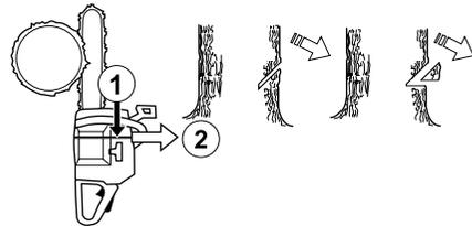
Die Schnitttiefe der Kerbe soll etwa 1/4 des Stammdurchmessers und der Winkel zwischen dem oberen und unteren Schnitt mindestens 45° betragen.
