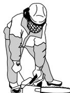
Den Startgriff mit der rechten Hand fassen und das Startseil bis zum ersten Widerstand (die Starterklinken rasten ein) langsam herausziehen, danach das Seil schnell und kraftvoll herausziehen, bis der Motor startet.
