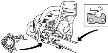
Darauf achten, dass die Schneiden der Sägezähne auf der Schienenoberseite nach vorn gerichtet sind.
