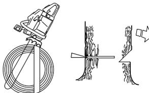
Der Fällschnitt soll parallel zur Kerbschnittlinie abschließen, so dass der Abstand zwischen beiden Schnitten mindestens 1/10 des Stammdurchmessers
