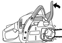
Kettenspannrolle lösen und Kupplungsdeckel (Kettenbremse) entfernen. Transportschutz entfernen. (A)
