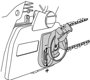
Die Kette ist korrekt gespannt, wenn sie von der Schienenunterseite nicht durchhängt, aber noch problemlos von Hand gedreht werden kann. Die Schienenspitze nach oben halten und die Schienenkupplung durch Drehen des Knaufs im Uhrzeigersinn anziehen.
