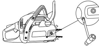
Die Kette ist korrekt gespannt, wenn sie an der Schienenunterseite nicht durchhängt und von Hand noch leicht herangezogen werden kann. Die Schienenmutter mit dem Kombischlüssel anziehen und dabei gleichzeitig die Schienenspitze hochhalten.
