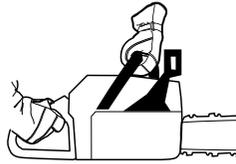
Geben Sie Vollgas und betätigen Sie die Kettenbremse, in dem Sie das linke Handgelenk gegen den Handschutz drehen. Lassen Sie den vorderen Handgriff nicht los. **Die Kette soll sofort stoppen.**
