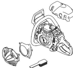
Das Kühlsystem einmal pro Woche mit einer Bürste reinigen, bei schwierigen Verhältnissen öfter. Eine Verschmutzung oder Verstopfung des Kühlsystems führt zur Überhitzung des Gerätes, die Schäden an Zylinder und Kolben zur Folge haben kann.
