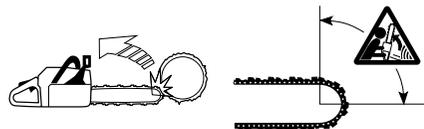
Das Sägen mit der Unterseite der Führungsschiene, d.h. von der Oberseite des Baumstammes nach unten, wird als Sägen mit ziehender Kette bezeichnet. Die Motorsäge wird zum Baumstamm hingezogen und die Vorderkante des Motorsägenkörpers fungiert als natürliche Stütze am Stamm. Beim Sägen mit ziehender Kette hat der Anwender eine bessere Kontrolle über die Motorsäge und über den Rückschlagbereich der Führungsschiene.
