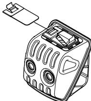
Gitter in der richtigen Position einsetzen. Gegebenenfalls zum Einsetzen oder Entfernen des Gitters Ringmaulschlüssel verwenden.
