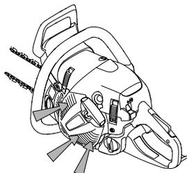
**WICHTIG!** Um die Funktion der Zentrifugalreinigung aufrecht zu erhalten, muss diese regelmäßig gewartet und gepflegt werden. Den Lufteinlass der Startvorrichtung, die Gebläseflügel des Schwungrads, den Raum um das Schwungrad, das Ansaugrohr und den Vergaserraum reinigen.
