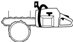
Es gibt Methoden zum Fällen von Bäumen, deren Stammdurchmesser größer ist als die Führungsschiene. Bei solchen Methoden besteht große Gefahr, dass der Rückschlagbereich der Führungsschiene mit einem Gegenstand in Berührung kommt.
