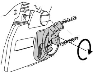
An einer neuen Kette muss die Kettenspannung oft kontrolliert werden, bis die Kette eingefahren ist. Die Kettenspannung regelmäßig prüfen. Mit einer richtig
