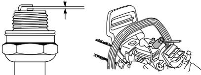
Hinweis! Stets den vom Hersteller empfohlenen Zündkerzentyp verwenden! Eine ungeeignete Zündkerze kann Kolben und Zylinder zerstören. Dafür sorgen, dass die Zündkerze eine sog. Funkenstörung hat.
